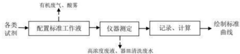
图 2.10-2 标准工作液配制流程图
