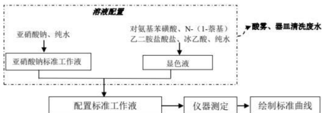
图2-6标准工作液配置流程图
